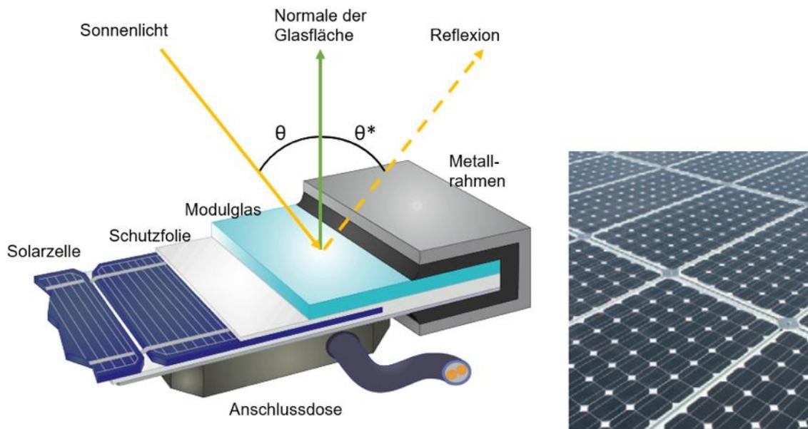
Abbildung 3: Aufbau eines PV-Moduls und Darstellung des Reflexionsgesetzes „Einfallswinkel = Ausfallswinkel“
